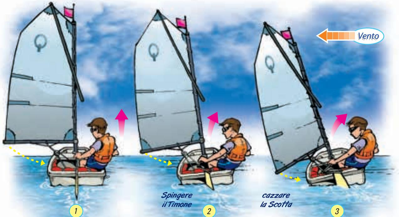
CON IL TERMINE **Poggiare** SI INTENDE LA MANOVRA CHE CONSISTE NELL'ALLONTANARE LA PRUA DELLA NOSTRA IMBARCAZIONE DALLA DIREZIONE DA CUI PROVIENE IL VENTO.
