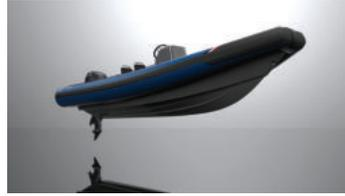
Carena affusolata realizzata con resina vinilestere, tessuti bidirezionali ed accoppiati e struttura di rinforzo interna. La procedura costruttiva garantisce elevata resistenza e rigidità.
