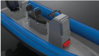
Zona di comando caratterizzata da ergonomia e praticità nella disposizione dell'allestimento tecnico e nella capacità di stivaggio. Corrimano console, portello a baionetta per accedere all'area tecnica, vano a giorno per l'alloggiamento del serbatoio di riserva (amovibile). Il serbatoio benzina (95 lt), si trova sotto il portello della panca jockey.
