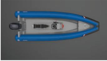
Battello realizzato in doppia stampata: coperta in sandwich da poppa a prua. Maggiore resistenza strutturale e elevato grado di finitura complessiva.
