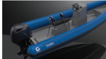
La postazione di guida è studiata per un'ottima condizione di guida da seduti o in piedi. La panca è una jockey biposto con doppio schienale e maniglia per pilota e co-pilota. Cuscini ad elevato spessore per garantire il massimo confort. Asta traino OPT con sistema di ancoraggio in tre punti (panca, schienale e coperta).
