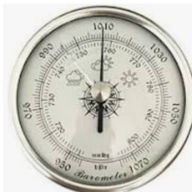
**Il barometro è uno strumento che misura la pressione atmosferica, ovvero il peso dell'aria. La sua unità di misura è l'hectopascal. Prima di questa unità di misura vi era il millibar, mentre Torricelli per il suo esperimento con la colonna di Mercurio utilizzava i millimetri.**
